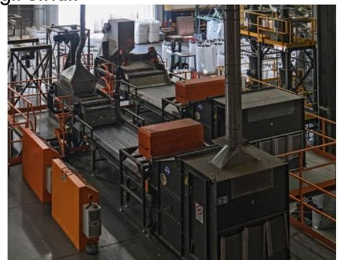
Alla selezione seguono le fasi di lavaggio e separazione di inquinanti mediante flottazione, seguita da granulazione.
