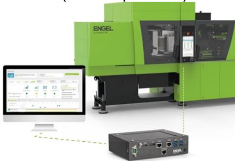
Al K2019, Engel presenterà due nuove funzionalità della serie iQ (Intelligent Quality): iQ process observer (foto a sinistra) è il modulo per il monitoraggio proattivo dell'intero processo di stampaggio, che controlla in tempo reale centinaia di diversi parametri nelle fasi di plastificazione, iniezione, raffreddamento e demoulding, identifica eventuali scostamenti e li comunica all'operatore, che può così intervenire prontamente. iQ Melt è invece dedicato al
