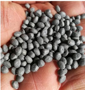
Le prime due aziende ad aderire al progetto sono state EcoPlasTeam e Korec. La prima si è specializzata nel riciclo di imballaggi poliaccoppiati (PE/Al), dal quale ottiene un nuovo materiale sotto forma di granulo plastico "glitterato" colorabile e perfettamente lavorabile per ottenere nuovi oggetti in plastica ([leggi articolo](#)).
