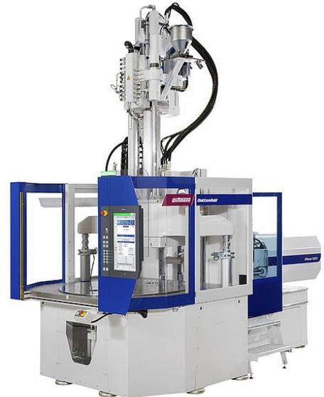
Nella configurazione bicomponente, il secondo sistema idraulico - che nelle macchine standard serve l'estrazione - alimenta invece il gruppo di iniezione secondario, in modo tale da consentire una sovrapposizione dei movimenti e l'iniezione contemporanea del materiale dalle due unità.
