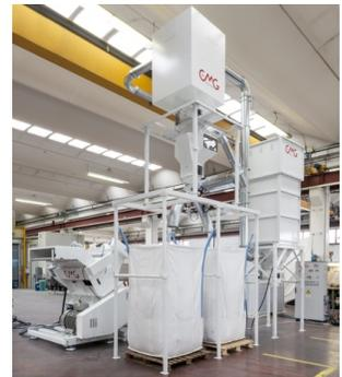
Infine, al K2019 CMG presenterà anche la nuova serie di sistemi di evacuazione VP (sarà esposto il modello VP400), la cui principale caratteristica è la totale assenza di rilascio di particelle di polvere in ambiente, problema molto comune nei sistemi di trasporto del rimacinato.
