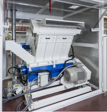
**DALLO STAMPAGGIO ALLA TERMOFORMATURA.** Passando agli ambiti tecnologici, nello stampaggio ad iniezione, con particolare focus sulle applicazioni precisione, CMG lancia al K le nuove serie G17 e G25 ottimizzate per installazione a bordo pressa, dotate di lame rotanti a taglio tangenziale per ottenere massima precisione di taglio, omogeneità delle dimensioni e forma del rimacinato e assenza di polvere.
