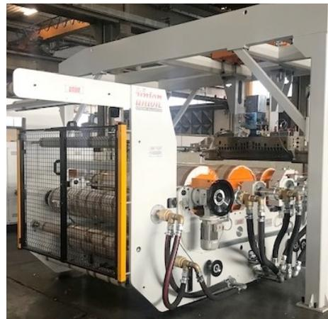
Cuore della linea è un estrusore monovite a doppio degasaggio, alimentato con 100% materiale riciclato, proveniente da post-consumo e scarti industriali, abbinato ad una calandra meccanica inclinata, con cilindri da 500-800-500 mm, per garantire una portata oraria di 1.300 kg (PET).
