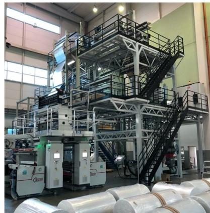
Fondata nel 1963, Costruzioni Meccaniche Tecom è specializzata nella costruzione di linee di estrusione in bolla a marchio GoBio per film in poliolefine e biopolimeri compostabili da 1 a 3 strati, destinate ad applicazioni di sacchettame (congelatore, shopper e spazzatura), film agricoli, film per imballaggio termoretraibile e per pallettizzazione.
