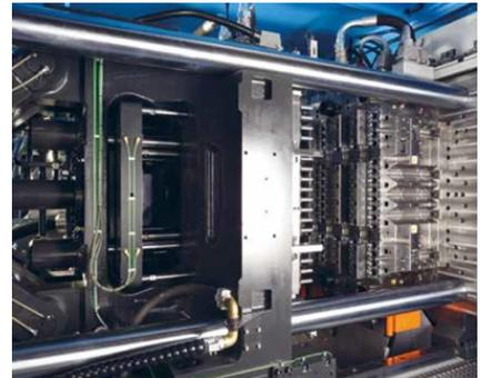
Tra gli accorgimenti introdotti nell'ultima generazione, alcuni sono dedicati a semplificare gli interventi di manutenzione: ad esempio - spiega il costruttore veneto - , è stato modificato il layout in modo da poter montare gli accumulatori su un rack estraibile all'interno del telaio della macchina. Inoltre, il serbatoio dell'olio è stato riprogettato in modo da non dover essere svuotato in caso di manutenzione (può essere utilizzato anche ad altitudini fino a 3000 m senza alcuna modifica).
