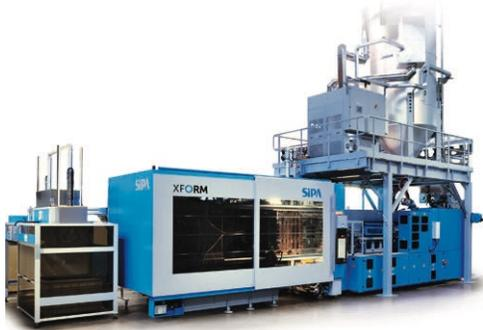
La tecnologia XForm per lo stampaggio di preforme PET, proposta da Sipa (Zoppas Industries), si aggiorna e, per l'occasione, vede l'introduzione del nuovo modello XForm 250 con forza di chiusura di 250 tonnellate, che si aggiunge a quelli da 350 e 500 ton, con possibilità di montare stampi rispettivamente da 96, 128 e 180 cavità.
