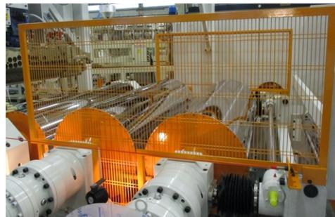
L'impianto si basa su un estrusore bivate ZP 112 / 52 D a 4 degasaggi affiancato da un estrusore monovite TR 90 / 44 D in co-estrusione, al fine di produrre una foglia stratificata tipo A-B-A destinata alla termoformatura di contenitori alimentari. La foglia, con larghezza utile di 1.600 mm e spessore variabile da 130 a 1.800  $\mu$ , viene prodotta con una capacità oraria fino a 1.700 kg/h.
