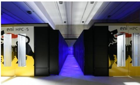
Messo in funzione a febbraio, HPC5 affianca il sistema precedente (HPC4) triplicandone la potenza di calcolo da 18 a 52 PetaFlop/s, vale a dire 52 milioni di miliardi di operazioni matematiche al secondo, permettendo all'ecosistema di supercalcolo di raggiungere una potenza di picco totale pari a 70 PetaFlop/s. Potenzialità di calcolo d'eccellenza, che in questo momento di emergenza saranno a disposizione della ricerca medica. Il supercomputer è ospitato nel Green Data Center di ENI a
