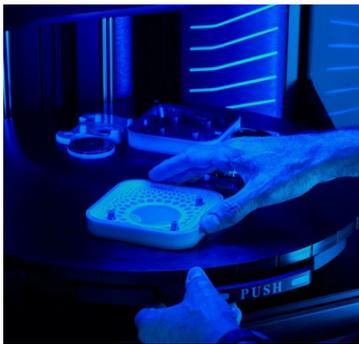
La stampante J55 si caratterizza per la piattaforma di lavoro rotante con testina di stampa fissa, soluzione sviluppata per aumentare l'affidabilità, ridurre la rumorosità e semplificare gli interventi di manutenzione. Secondo il costruttore, durante il funzionamento è silenziosa come un frigorifero di uso domestico, mentre tecnologia di filtraggio ProAero garantisce l'assenza di odore, agevolandone così l'installazione in uffici e laboratori.
