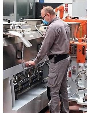
Cuore della linea è un estrusore bivate co-rotante ad alta coppia, modello HT, caratterizzato da doppia alimentazione laterale per le cariche e da degassaggi potenziati con pompe ad alto vuoto per l'estrazione delle sostanze volatili.
