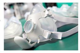
La mascherina viene stampata con due diversi materiali: il corpo è in silicone liquido (LSR) bicompatibile Elastosil LR 5040 fornito da Wacker, morbido e confortevole per il viso, mentre il supporto in cui si agganciano gli elastici e accoglie il filtro è in polipropilene (Borealis). Al centro del dispositivo è presente un alloggiamento per gli elementi filtranti in tessuto non tessuto.
