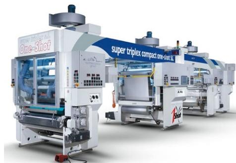
Lunga una ventina di metri, la nuova accoppiatrice a 3 layer per strutture multistrato può arrivare a ridurre dell'80% il consumo energetico e del 35% l'utilizzo di materie prime rispetto alle linee convenzionali, con un taglio dei tempi di lavorazione di circa la metà. Il controllo è in linea con l'approccio industria 4.0 per quanto concerne remotabilità e interconnessione.
