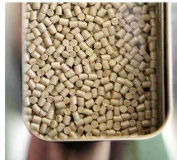
Evonik produce e vende un'ampia gamma di tecnopolimeri PEEK, con bassa o alta viscosità, in forma di granuli e polveri, tal quali o rinforzati con fibre di vetro o di carbonio. Nell'ambito dei tipi ad alta viscosità. Vestakeep 4500 G si differenzia dal grado L4000 G per velocità di cristallizzazione e scorrevolezza, oltre che per una maggiore rigidità del fuso e una più elevata resistenza termica.
