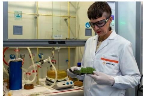
I campi di erba artificiale non sono facili da riciclare poiché vengono utilizzate per i fili e gli intasi diverse tipologie di plastica; per questa ragione il fine vita è generalmente la discarica, ad eccezione della gomma utilizzata come riempitivo.
