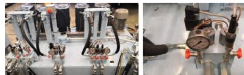
L'efficientamento energetico è stato ottenuto adottando pompe indipendenti, controllate da motori brushless: è stato così possibile ridurre del 30% il consumo energetico sulle produzioni di stivali in tricolore, con un taglio delle emissioni sonore del 70%.
