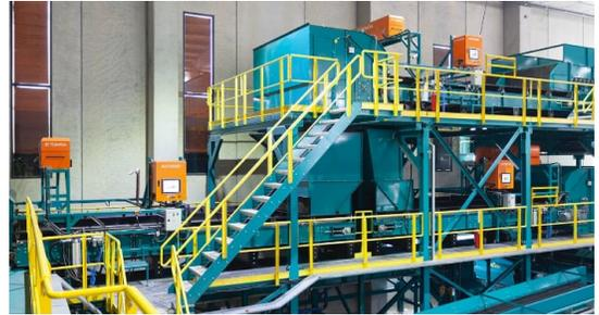
L'unità Autosort è collocata all'inizio dell'impianto, dopo la fase di preselezione, per eseguire una prima selezione dei flussi di rifiuti plastici; a valle, una macchina Autosort Flake elimina dalle scaglie le ultime impurità e seleziona il materiale in base a colore, polimero o metallo, anche quando la miscela contiene parti estranee di piccole dimensioni.
