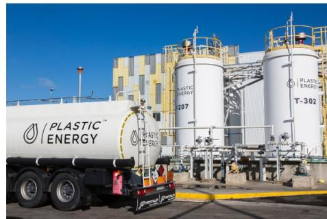
La tecnologia di riciclo chimico TAC (Thermal Anaerobic Conversion) messa a punto da Plastic Energy prevede la conversione termochimica, in assenza di ossigeno, di rifiuti di plastica mista (difficili da riciclare per via meccanica) in un olio sintetico (Tacoil), che può essere impiegato come materia prima per produrre nuove materie plastiche e biocarburanti.
