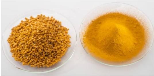
Lanxess ha ampliato la gamma di pigmenti gialli resistenti al calore, Colortherm Yellow, per soddisfare la domanda proveniente dalle applicazioni nei tecnopolimeri, dove è necessaria una stabilità con temperature più alte, che solo i prodotti inorganici possono garantire.
