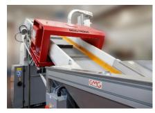
Il granulatore esegue un taglio di massima precisione ed è dotato di motori ad alta potenza ed efficienza (EISA Premium Efficiency), mentre il sistema di evacuazione, depolverazione e filtrazione della polvere provvede ad un accurata movimentazione delle rilevanti quantità di macinato. Il materiale in uscita risulta quindi di dimensioni omogenee, sufficientemente piccolo da poter essere riprocessato senza generare interruzioni
