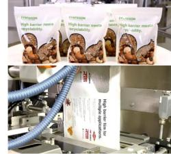
L'imballo flessibile vanta robustezza, rigidità e buon aspetto estetico, oltre ad essere idoneo alla produzione con linee confezionatrici VFFS (Vertical Fill Form Seal), anche ad alta velocità.
