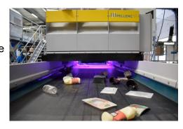
L'unità, che combina la tecnologia di filigrana digitale con quella a infrarossi NIR/VIS, ha raggiunto un tasso di selezione superiore al 95% e sarà presto installata presso l'Amager Resource Center (ARC) di Copenhagen per la fase di test su scala semi-industriale, che durerà quattro mesi.
