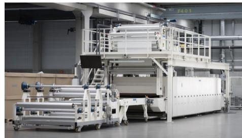
La nuova pressa ha una larghezza fino a 1.800 mm e può operare con un range variabile di temperature in funzione delle esigenze operative; può lavorare anche materiali unidirezionali (UD), a struttura incrociata, laminati e sandwich utilizzando diverse combinazioni di matrici polimeriche e fibre, tra cui carbonio, vetro, aramidica e fibre naturali.
