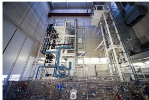
I catalizzatori ODH di Clariant sono formulati in modo specifico per l'innovativa tecnologia EDHOX di Linde Engineering: a differenza dello steam cracking convenzionale, dove le temperature di processo raggiungono anche 900°C, EDHOX opera sotto i 400°C, consentendo emissioni di CO2 relativamente basse.
