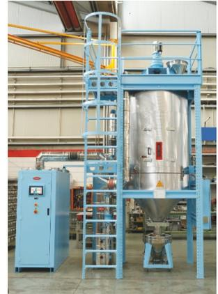
Nella sua versione più recente - afferma Moretto - MPK è di più semplice utilizzo, centralizzando in un unico controllo, posto nel corpo dell'essiccatore, la gestione di tutti i processi. Un'altra caratteristica dell'apparecchio è la pulizia, elemento critico in macchinari che trattano materiale proveniente da post consumo, come rimacinato e flakes, soprattutto per contenere al minimo i tempi di cambio produzione o lo spurgo dei filtri.
