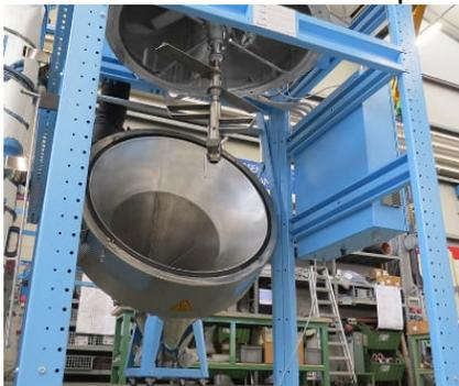
In questo, è d'aiuto il cono apribile (foto a sinistra) con dispositivo assistito, che consente all'operatore di procedere celermente alla pulizia o alla manutenzione, grazie al sistema di apertura che richiede solo un paio di minuti per completare l'operazione.
