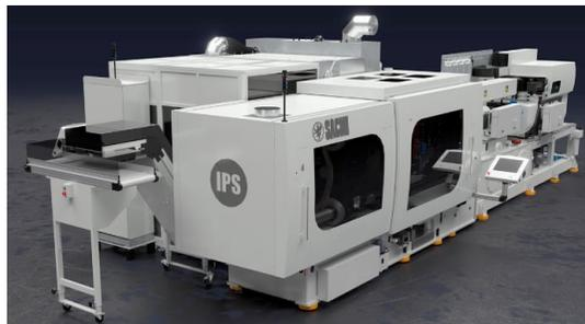
Come le precedenti, l'ultima versione IPS (Injection Preform System) può montare diversi tipi di stampi, anche prodotti da terzi: con 24 cavità per colli di 48 mm, oppure fino a 96 cavità per 30 mm di collo. Inoltre, sfruttando la tecnologia "Nano-pitch" del partner MHT, è possibile montare stampi con 128 cavità per i colli 26/22 mm.
