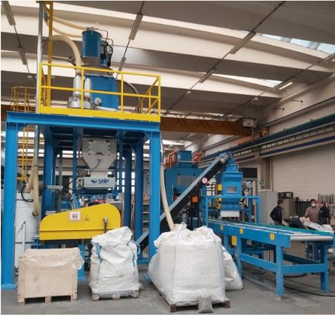
SAIP, società comasca attiva nella costruzione di macchine e impianti per la lavorazione di poliuretano, ha messo a punto Repur, una tecnologia per il riciclo di scarti di poliuretano e MDF truciolare in polvere, attraverso un processo chimico e meccanico a basso impatto ambientale.
