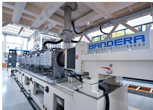
**SINGOLA O IN CASCATA?** Le due linee di estrusione possono essere utilizzate singolarmente o in tandem modalità cascata. Destinata alla produzione di compound di polipropilene con aggiunta di cariche, la serie Revotech® Twin è in grado di trattare gli scarti della lavorazione di film rigidi per ottenere un risultato più raffinato di quello iniziale. In altre parole, è in grado di operare un upcycling delle caratteristiche del granulo partenza, proveniente da sfrido, migliorandone le proprietà.
