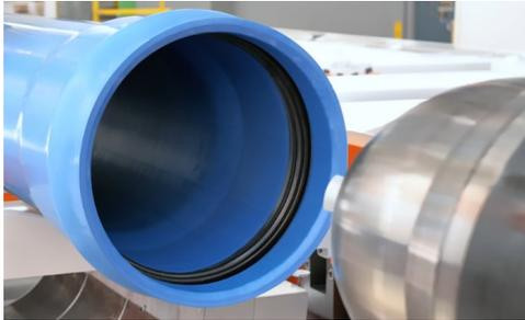
Il costruttore di macchine per la lavorazione di tubi in plastica SICA ha sviluppato una macchina in grado di eseguire una bicchieratura Rieber anche su tubi in PVC orientato (PVC-O) e non solo su quelli in PVC convenzionale per tubazioni (PVC-U).
