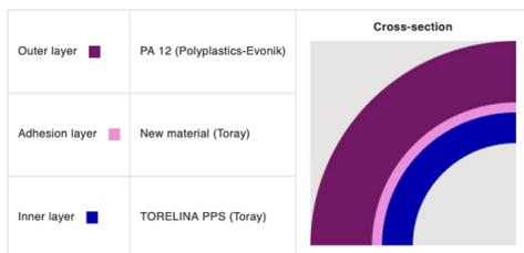
Negli ultimi anni sono cresciute le implementazioni di tubi monostrato in poliammide e di quelli multistrato con layer interno in polipropilene per ridurre il peso e, di conseguenza, il consumo di carburante, rispetto alle convenzionali soluzioni in metallo. Il limite di queste strutture polimeriche - afferma Toray - riguarda la resistenza al calore e all'idrolisi,
