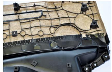
Il programma fieristico comprende anche applicazioni di stampaggio di imballaggi mediante inietto-compressione e IML (su una pressa EcoPower Xpress 160/1100+), di pannelli porta in PP riciclato e fibra naturale (MacroPower1100/12800, nella foto), fino allo stampaggio di silicone liquido per produrre chiusure e membrane per altoparlanti, rispettivamente con presse SmartPower 120/350 LIM e Combimould MicroPower15/10H/10H.
