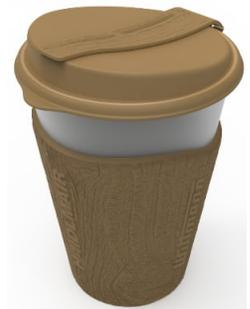
un guscio di polipropilene e schiumata mediante Cellmould, mentre in una cavità separata dello stampo viene prodotta la chiusura, anch'essa in PP Borneables, ma di colore diverso, se richiesto. Tra le particolarità dell'allestimento, l'utilizzo di elementi ibridi nello stampo per ottimizzare il raffreddamento: acciaio lavorato all'utensile e bronzo giallo stampato in 3D.
