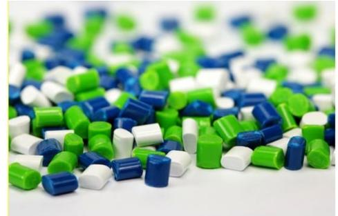
La prima novità è Novodur ECO MR P2H-AT, gradi ABS per uso generale contenenti una percentuale di materiale da riciclo meccanico post-consumo del 30, 50 o 70 per cento, offerti in versione nera, colorata o colorabile. Caratterizzati da buon scorrimento, rigidità e lucentezza, questi tipi consentono una riduzione dell'impronta di carbonio fino al 57%. I primi gradi sono attualmente in fase di valutazione presso alcuni clienti per applicazioni nei casalinghi.
