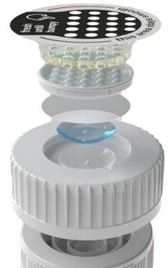
Il risultato è un sistema composto da una chiusura con base e cappuccio, quest'ultimo contenente l'attivatore con il gel inventato da Mimica, protetto una vaschetta antiurto e rivestito da un sottile foglio di alluminio la cui superficie diviene sempre più irregolare ma mano che il cibo si deteriora.
