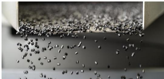
La vicentina Xenia Materials ha messo a punto la nuova famiglia di compositi termoplastici con fibra di carbonio Xecarb ST, modificati per garantire un superiore allungamento a rottura e migliorata resistenza all'urto alle basse temperature, specialmente con intaglio.
