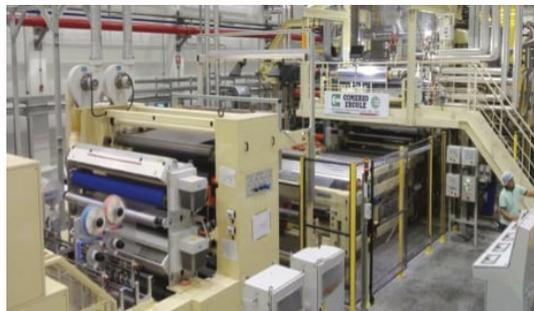
La sua configurazione a "L rovesciata" consente un'ampia gamma di applicazioni poiché è progettata per operare con 3 banchi di laminazione come una calandra a 4 rulli, oppure con 4 banchi di laminazione come una 5 rotoli, mantenendo lo stesso allestimento post-calandra e di goffratura del film.
