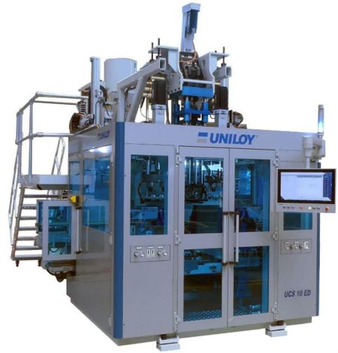
Gli impianti per estrusione-soffiaggio in continuo UCS.E, con movimento del carro 'shuttle' e forza di chiusura fino a 30 tonnellate, sono indicati per la produzione in costruzione fino a 7 strati di bottiglie, flaconi, contenitori e articoli tecnici con capacità da 50 ml fino a 30 litri.
