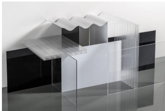
Le nuove lastre traslucide possono contenere fino al 50% di PMMA proveniente da sfridi e scarti di produzione, soluzione che riduce l'impronta di carbonio del materiale da costruzione. Oltre alla protezione UV, il materiale è modificato per assicurare la massima resistenza agli urti, quindi a prova di grandine. Le lastre vengono fornite con una garanzia di 30 anni contro l'ingiallimento.
