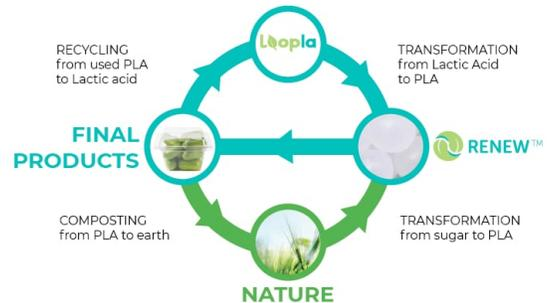
La nuova bioraffineria, nelle intenzioni della società belga, sorgerà nell'area industriale di Port-Jérôme, lungo la Senna, tra Rouen e Le Havre, con una capacità produttiva pari a 75mila tonnellate annue di biopolimero. Sarà integrata a monte con la sintesi di acido lattico da biomasse di origine agricola (sottoprodotti) e a valle attraverso il riciclo molecolare (depolimerizzazione) dei rifiuti a base PLA, con tecnologia proprietaria Loopla.
