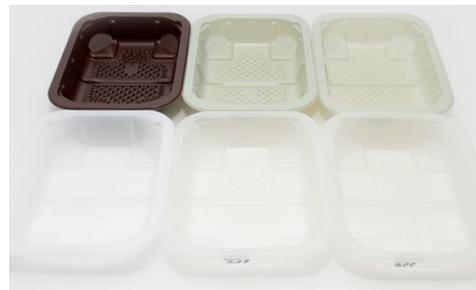
Il processo NextLoopp prevede una accurata selezione dei materiali in entrata mediante traccianti, in modo tale da separare il polipropilene contenuto negli imballaggi alimentari, che viene poi sottoposto a decontaminazione al fine di consentirne il riutilizzo in nuovi packaging e articoli a contatto con alimenti, in conformità agli standard in vigore nella UE, nel Regno Unito e negli Stati Uniti.
