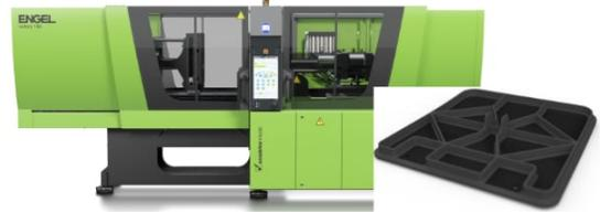
L'isola di stampaggio automatizzata allestita per la fiera si articola su una pressa senza colonne victory 660/160 (nella foto), integrata con un robot easix e un forno a raggi in infrarossi - anch'esso realizzato da Engel - per il pre-riscaldamento delle foglie "organiche" che costituiscono l'anima del rinforzo; queste vengono prelevate dal robot e introdotte nello stampo per il successivo sovrastampaggio a iniezione.
