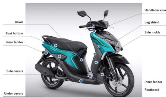
Il materiale sarà impiegato su larga scala sui modelli di ciclomotore per il commuting (utilizzati per spostamenti di breve e medio raggio) a partire da quest'anno. Nella foto sono mostrate alcune applicazioni di PP riciclato nel modello Gear125 destinato al mercato indonesiano.
