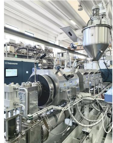
Questo risultato è reso possibile dal sistema di degasaggio particolarmente efficiente messo a punto dal costruttore torinese, in grado di eliminare l'umidità residua ed eventuali composti volatili presenti nel fuso.
