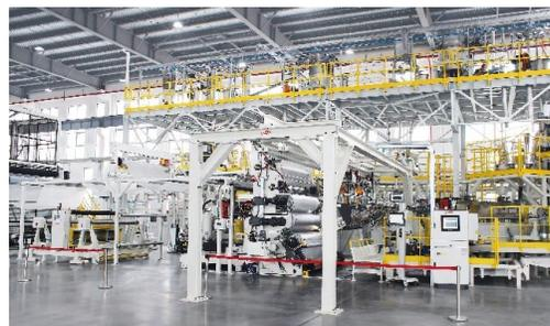
**LINEE CAST.** Un altro ambito di attività di costruttore novarese è la progettazione di linee Cast per la produzione di film estensibile. La tecnologia è ottimizzata per produrre ad alta velocità e garantire un avvolgimento di qualità. Gli impianti cast, dal design compatto, includono diversi sistemi quali il Rotofeed, ZeroFluff, Prowind 4.0.
