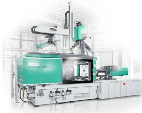
L'ultima macchina presente nello stand Arburg sarà una Allrounder More 1600 (foto a sinistra) per lo stampaggio di connettori Luer bicomponente (foto sopra) in polipropilene (0,2 g) e TPE morbido (0,05 g). Anche grazie a uno stampo cavità a 4+4 cavità dotato della tecnologia RotaricE2 di Braunform, il tempo di ciclo è di soli dieci secondi, senza necessità di assemblaggio finale.
