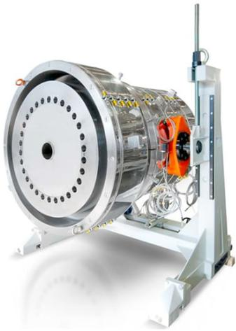
producendo tre diametri per filiera per dimensioni fino a 800 mm, in una classica configurazione di lavoro in stiro, mentre per dimensioni superiori, la modalità “swelling” e un accurato dimensionamento di filiere e calibri consentono una uniforme distribuzione della parete del tubo e dell’ovalizzazione, raggiungendo così produzioni fino a SDR 11 (109 mm) nel diametro 1.200 mm.
