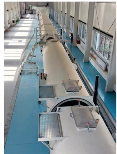
Per la produzione di tubi a basso spessore destinati ad applicazioni di teleriscaldamento viene applicato un trattamento superficiale tramite scarica elettrica. Il sistema corona garantisce un’adesione ottimale della schiuma poliuretanic, necessaria per l’isolamento del del tubo. Infine, il controllo qualità. Per la misurazione lungo tutta la circonferenza del tubo viene utilizzato un sistema a onde radar, con precisione pari a  $\pm 0,05$  mm.
