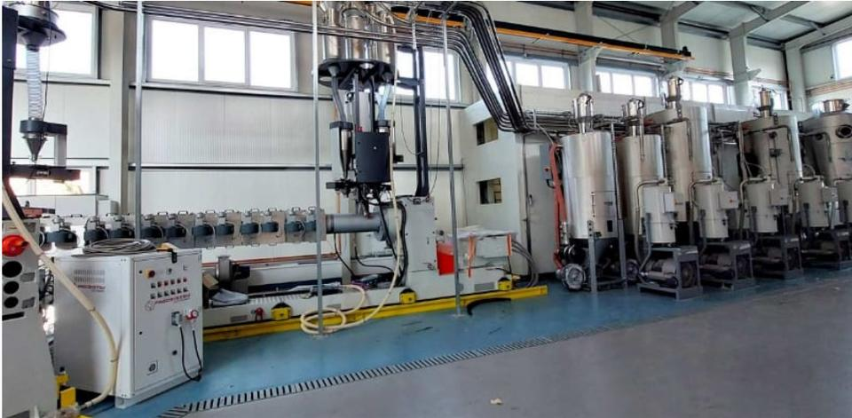
L'italiana Tecnomatic ha ricevuto dal produttore ceco di tubi in polietilene Luna Plast, già cliente, un ordine per una linea di estrusione ad alta tecnologia destinata alla produzione di tubi poliolefinici multistrato con diametro fino a 1.200 mm. L'impianto prevede anche la possibilità di inserire uno strato protettivo in polipropilene, nonché di estrudere tubi di rivestimento per teleriscaldamento.
