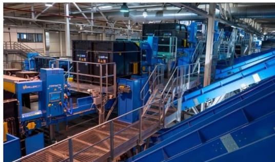
Basato su tecnologia fornita dalla materana Coparm, l'impianto molisano è in grado di trattare fino a 40.000 tonnellate annue di rifiuti plastici e, grazie a 10 selettori ottici forniti da Pellenc ST, riesce a suddividerli sia per famiglia polimerica che per colore, conforme ai requisiti e agli standard del consorzio Corepla per i centri di selezione spinta.
