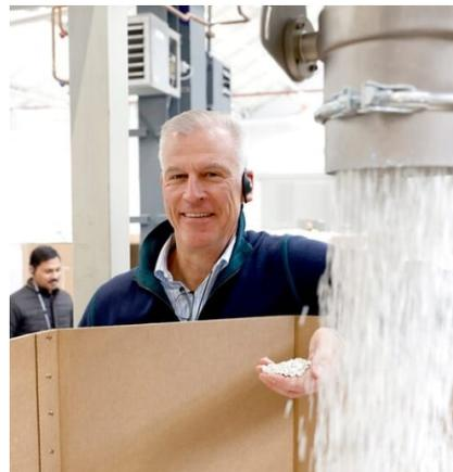
L'impianto funziona su quattro turni con una capacità di trattamento intorno a 15.000 tonnellate annue di serramenti in PVC provenienti da aziende partner che li raccolgono da serramentisti e demolizioni per poi sottoporli a una prima pre-selezione e pulizia grossolana.
