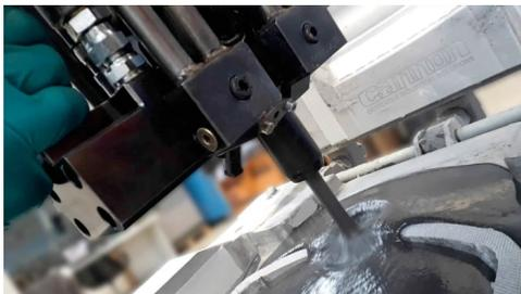
Un secondo sviluppo riguarda la grafite espandibile utilizzata come ritardante di fiamma per le schiume poliuretaniche. Cannon Afros ha ampliato l'offerta di teste di miscelazione multicomponente EG-AX per includere schiume viscoelastiche, pannelli sandwich continui e pannelli polyiso.
