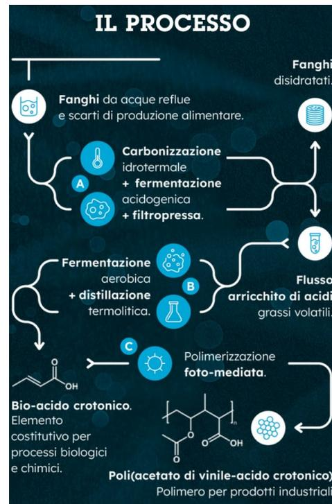
Nell'ambito del progetto, la società installerà un impianto dimostrativo presso il suo sito di Ravenna, dove - per 12 mesi - il processo di biosintesi sarà applicato ai fanghi in eccesso provenienti dall'impianto di trattamento delle acque reflue industriali.
